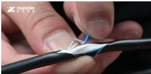
图 3 – 将热电偶插入中心电缆
