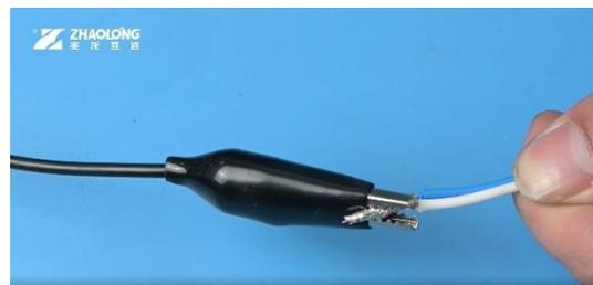
图 6 – 电缆两端的导体并联绞合
