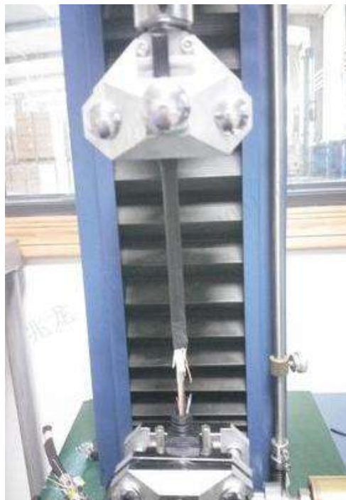
图 5: MDR 拉脱力试验后
