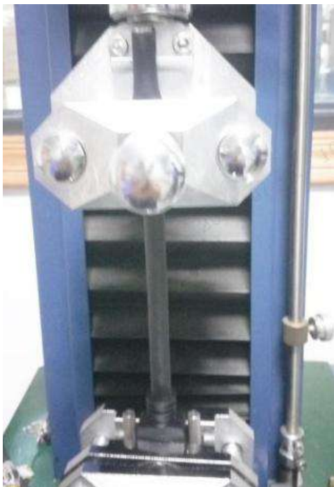
图 4: MDR 拉脱力试验中
