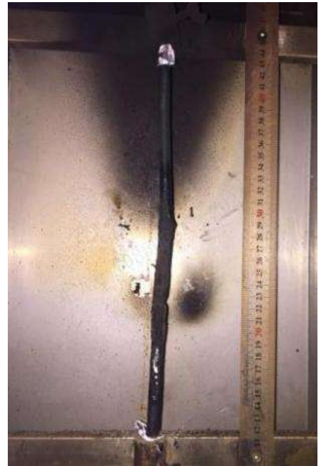
图 10：燃烧试验后样品三照片
