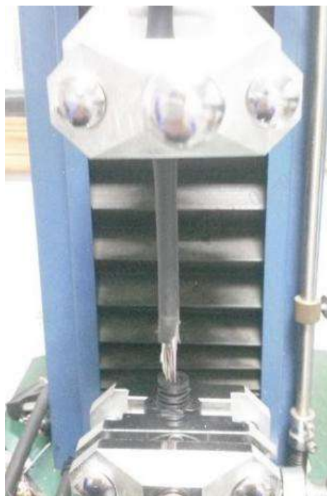
图 5：SDR 拉脱力试验后
