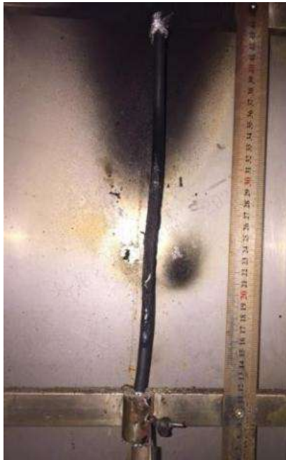
图 9：燃烧试验后样品二照片
