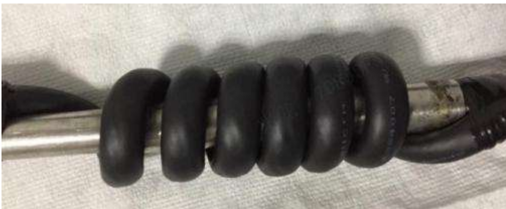
图 6：热冲击后样品照片
