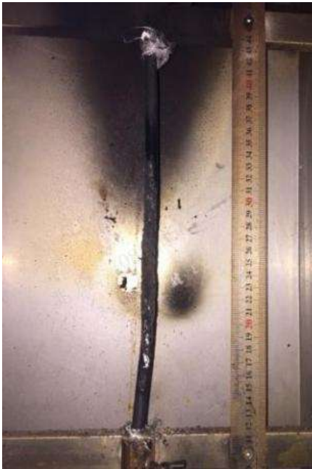
图 8：燃烧试验后样品一照片
