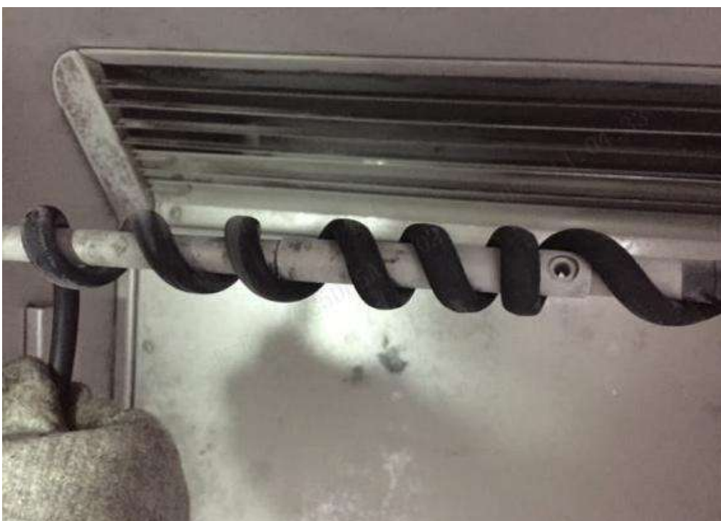
图 7：低温卷绕后样品照片
