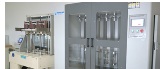
扭转试验说明 固定距离: 0.5m; 扭转角度: \pm 180^\circ 吊重: 500g; 速度: 60 次 / 分钟
